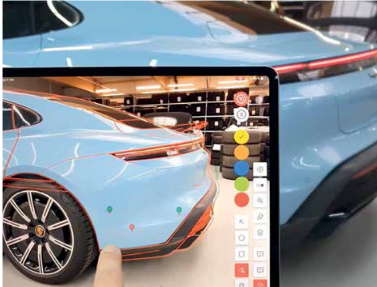
Soll-Ist-Vergleich mit dem AR-Qualitätsinspektionstool und Setzen von Checkpoints und Notizen
