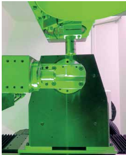
Laserbearbeitung der diamantbeschichteten Werkzeuge
