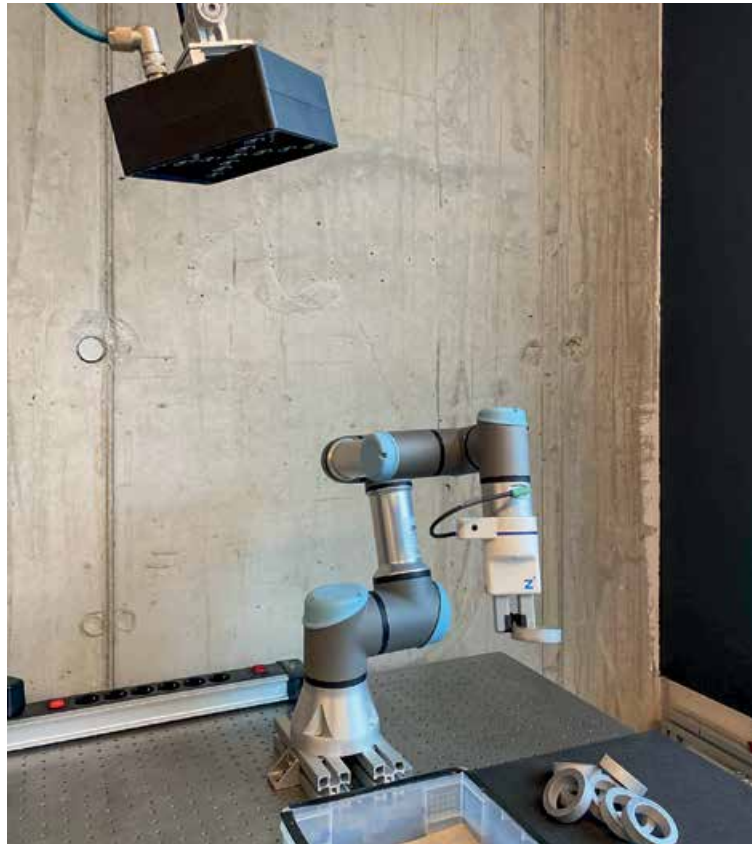
Einsatz des Lichtfeld-Sensors zur Unterstützung eines Handhabungsroboters bei der Erkennung von Bauteilen mit glänzender Oberfläche
