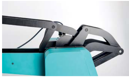
Innovativer, kinematischer Antrieb mittels Viergelenkketten
