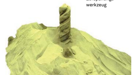
Additiv gefertigtes Zerspanungswerkzeug
