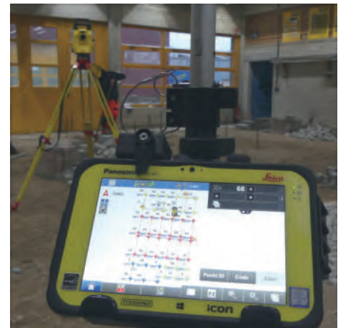
Abb. 3: Darstellung der Messpunkte des Tachymeters (Foto: KOMZET BAU BÜHL)
