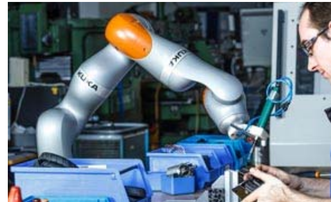
Sensorgeführter Montageprozess mit einem Leichtbauroboter
